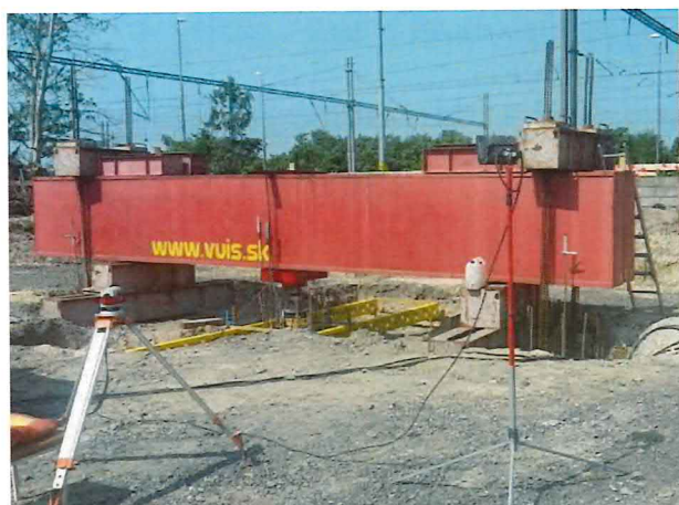
UČS 02, Zaťažovacia skúška pilóty
