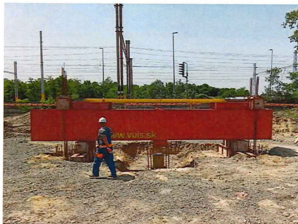
UČS 02, Zaťažovacia skúška pilóty príprava
